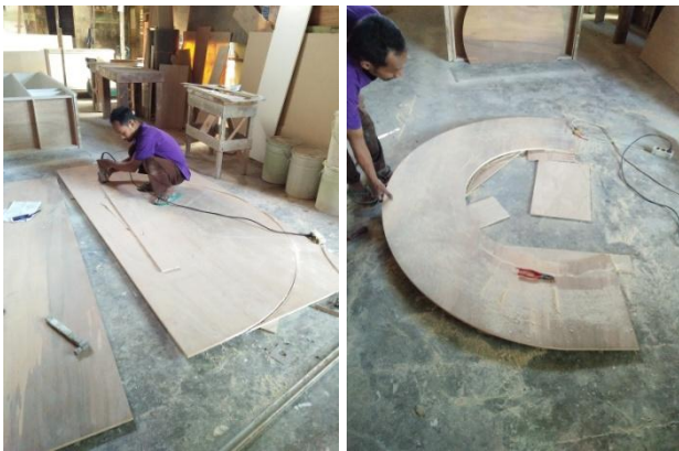
Gambar 27. Proses pemotongan multipleks untuk stool
