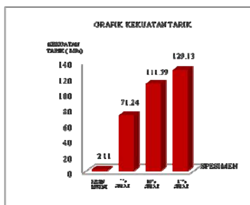
Gambar 4. Grafik tegangan tarik spesimen
