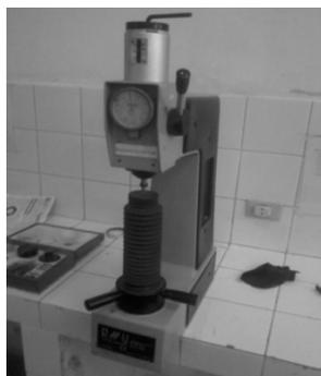
Gambar 13. Mesin Uji Brinell
