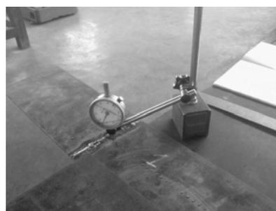
Gambar 16. Penghitungan distorsi sudut menggunakan *dial gauge*.
