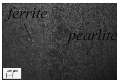
Gambar 19. Foto struktur mikro dari daerah *HAZ* menuju daerah Las dengan pengelasan multilayer menggunakan elektroda E 6013 (Pembesaran 50x).
