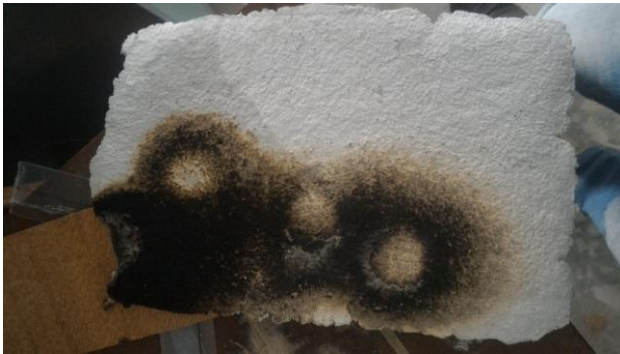
Gambar 4.2.11. Percobaan uji coba pembakaran partisi kertas dengan alat las suhu tinggi selama 10 menit.
