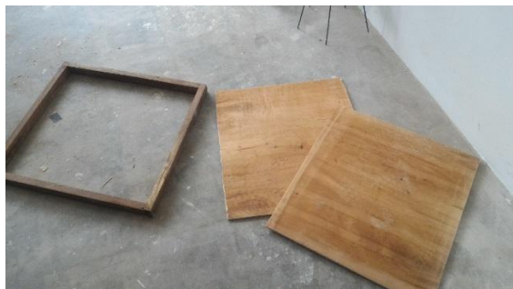
Gambar 4.2.5. Cetakan Balok beserta alas cetakan ukuran 60 x 60 cm
