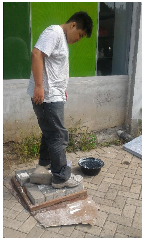
Gambar 4.2.8. Proses Pencetakan dan menekan kadar air dalam adonan kertas.
