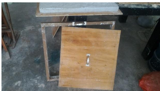
Gambar 4.2.6. Cetakan di beri pegangan agar mudah saat di tarik dalam proses pencetakan.
