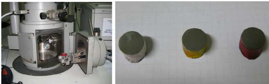
Gambar 2.5 Cuplikan sampel pada mesin uji SEM (kiri) dan temperatur pembentukan 600, 700, 800 °C (kanan)
