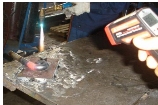
Gambar 2.3 Penggunaan infra red thermometer untuk mengontrol temperatur selama proses pembentukan
