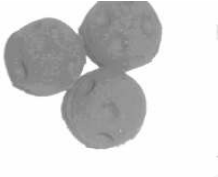
Gbr. 5. Briket promotor berbentuk bola dengan dimples
