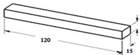
Gambar 1. Dimensi spesimen uji bending standar ASTM D790.
