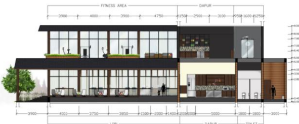
Gambar 19. Potongan B-B' Sumber: Okdiyanto (2014)
