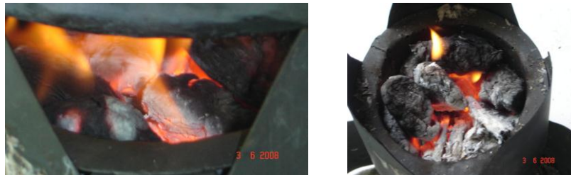
Gbr. 6. Abu dan bara briket kertas tidak mengempis meskipun di atasnya diletakkan umpan briket kertas yang baru, sehingga nampak seolah-olah bahan bakar masih penuh
