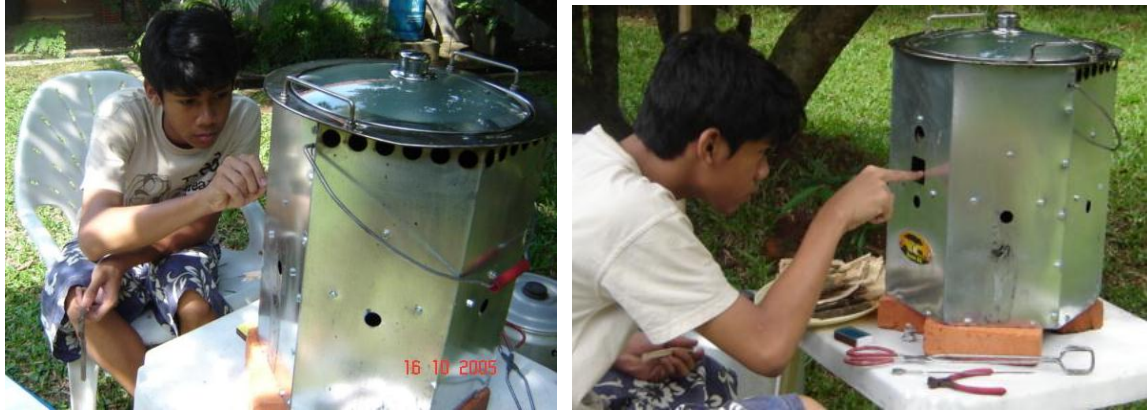
Gbr. 15 kiri: THE SAVE 80 tampak belakang, terlihat lubang lubang sirkulasi udara, panci menutup rapat bagian atas. kanan: THE SAVE 80 tampak depan dan samping, pelaku sedang memasukkan ranting.
