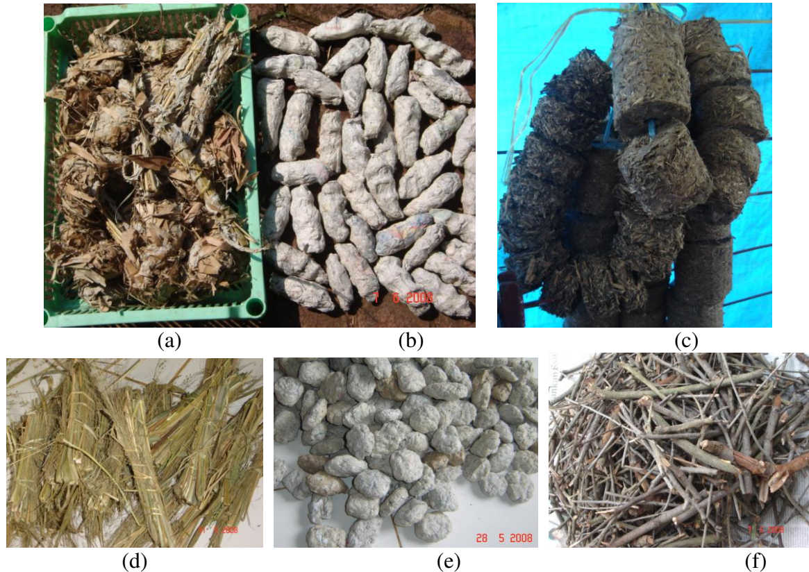
Gbr 2. (a) Briket campuran kertas-daun bambu. (b) Briket kertas bentuk memanjang, hasil peras genggam. (c) Briket campuran daun-rumput hasil pencetakan sederhana. (d) Ilalang ikat. (e) Briket kertas bentuk bulat pipih, hasil peras dua telapak tangan. (f) ranting kecil. Briket sampah alam sebaiknya disimpan dalam kantong berlubang-lubang dan digantung ditempat kering.
