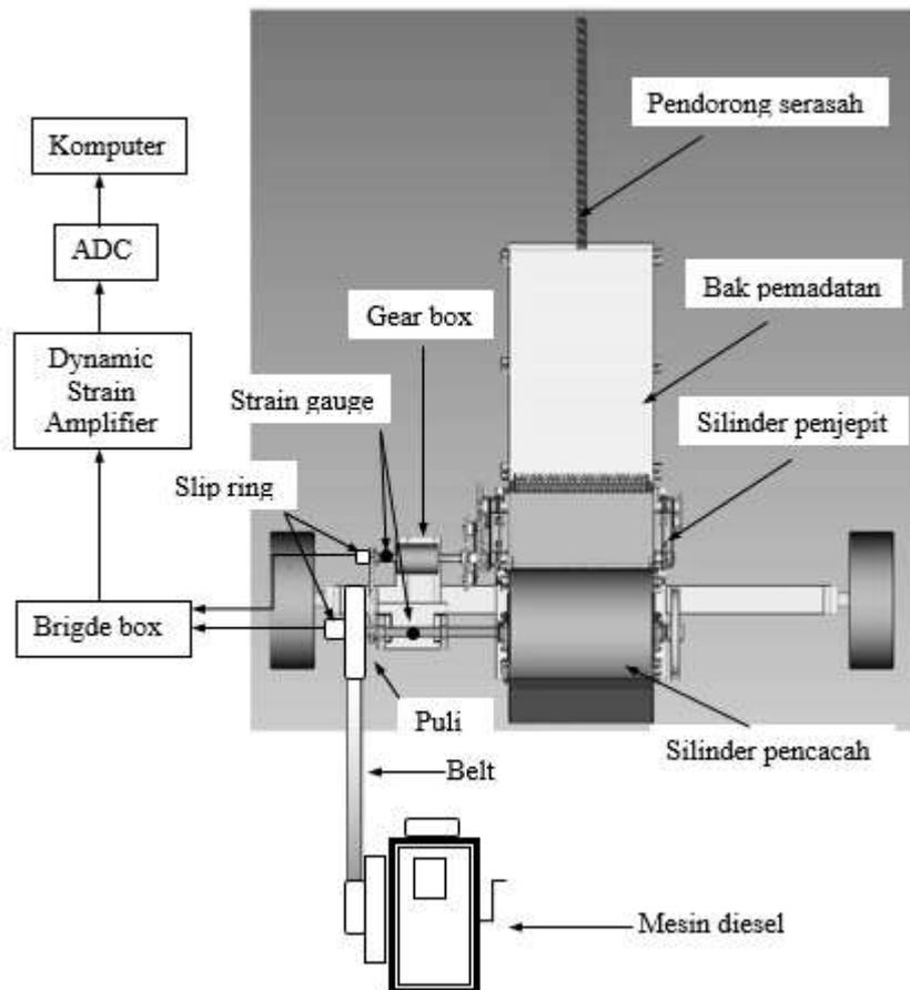
Gambar 3. Skema pengukuran torsi pemotongan serasah tebu.
