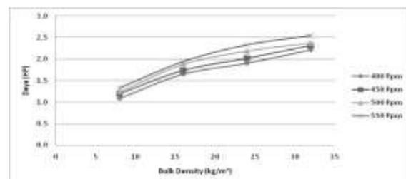
Gambar 6. Kebutuhan daya untuk mesin pencacah serasah tebu.
