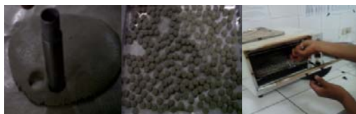
Gambar 1. Proses Pembuatan Pelet Fly Ash
