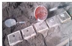
Gambar 8. Proses penuangan logam cair ke dalam cetakan pasir
