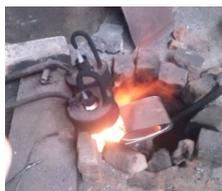
Gambar 7. Proses peleburan aluminium AA 1100 pada tungku pembakaran.
