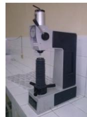
Gambar 9. Gambar alat uji kekerasan Brinell
