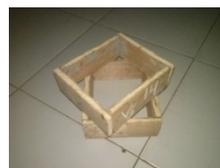
Gambar 3. Rangka cetakan pasir
