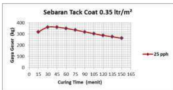
Gambar 4. Hubungan curing time dengan kuat geser variasi aspal 25 pph dengan takaran sebaran tack coat 0,35 ltr/m 2 perkerasan.
