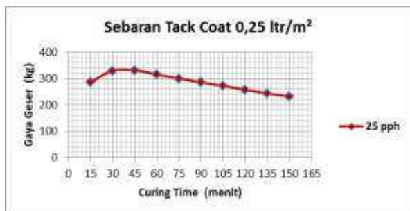
Gambar 3. Hubungan curing time dengan kuat geser variasi aspal 25 pph dengan takaran sebaran tack coat 0,25 ltr/m 2 perkerasan lentur
