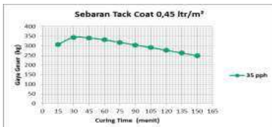
Gambar 17. Hubungan curing time dengan kuat geser variasi aspal 35 pph dengan takaran sebaran tack coat 0,45 ltr/m 2 perkerasan lentur
