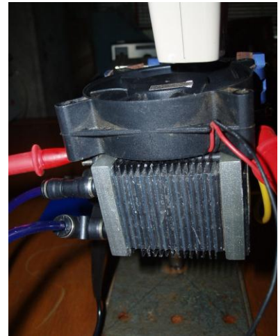
Gbr. 16. Stack Fuel Cell dengan fan
