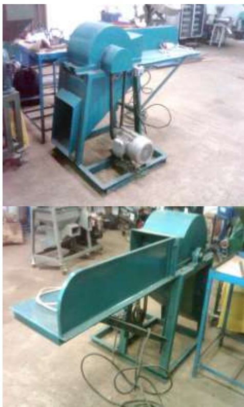
Gambar 5. Prototipe mesin pencacah rumput gajah dengan menggunakan pisau tipe reel
