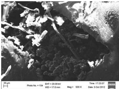
Gambar 7. Penampang patahan komposit 20% dengan pembesaran 500x
