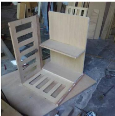
Gambar 18. Pembentukan rangka *side table*
