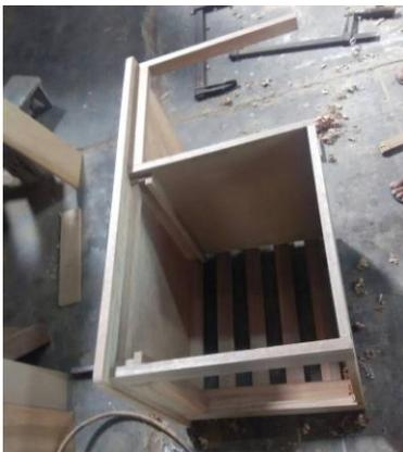
Gambar 19. Pembentukan rangka *coffee table*
