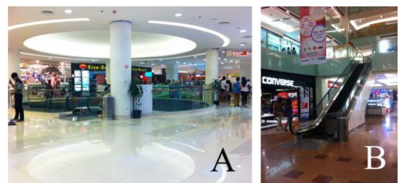
Gambar 16. Eskalator di “Tunjungan Plaza” 3 area B dengan konfigurasi paired paralel (A) dan single escalator (B)
