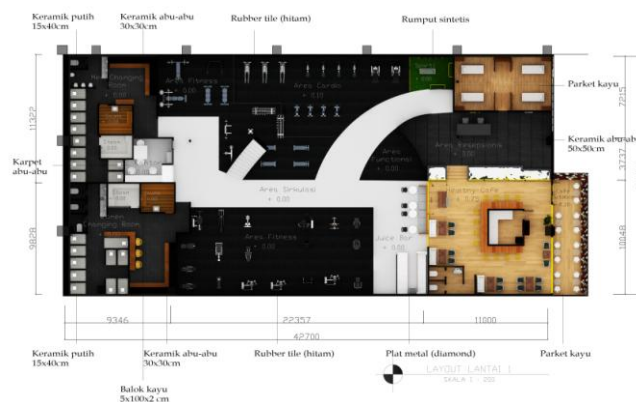
Gambar. 2. Transformasi Desain Layout Lantai 1
