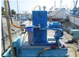
Gambar 2 . OWS Prototipe BBPPI
