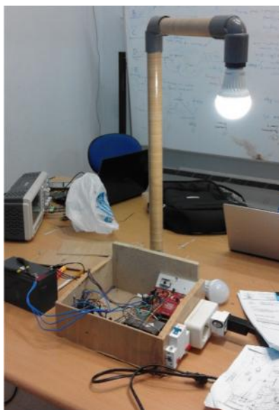
Gambar 6 Bentuk akhir hasil rancangan lampu darurat dan isi box rangkaian setelah dipasang lampu.
