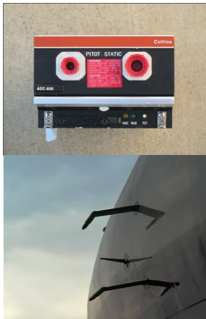
Gambar 3 Air Data Computer dan Intalasi pitot probe
