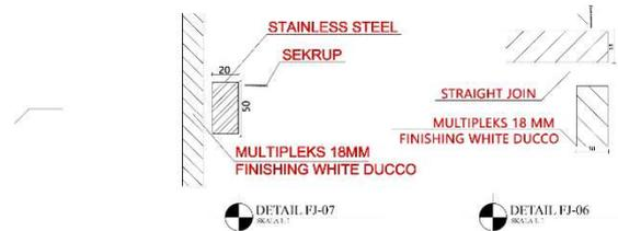
Gambar 62. Detail Pemasangan Meja Kasir Koperasi
