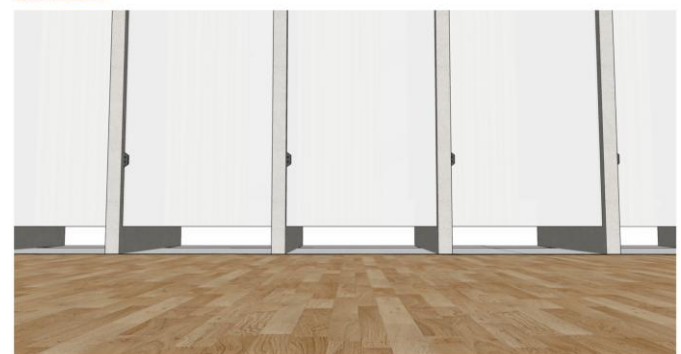
Gambar. 6. View CCTV di kamar mandi. Pemasangan CCTV berada pada ketinggian mata kaki untuk mengantisipasi pengguna yang jatuh di dalam. Sumber : Dokumen pribadi.
