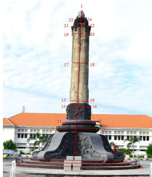
Gambar 3.2. Pengukuran 24 Titik Geometrik Tugu Muda
