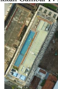
Gambar IV.11. Contoh/sampel pengaruh pertampalan foto yang kurang sempurna pada gedung tinggi yang menyebabkan masih adanya pergeseran relief
