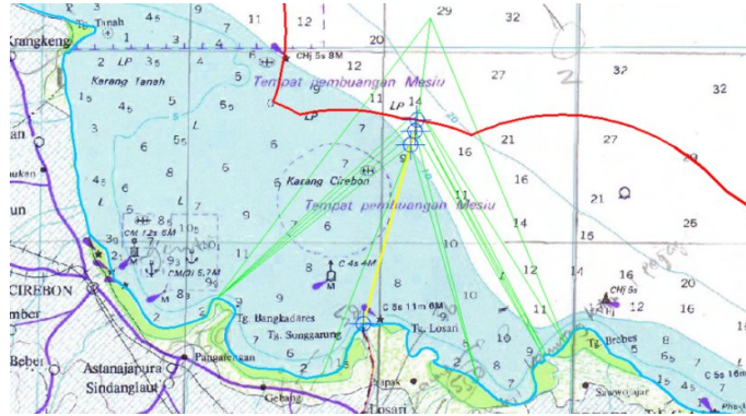
Gambar 4.1 Hasil penarikan batas dengan prinsip equidistance line
