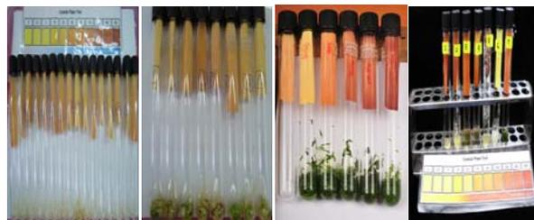
Gambar 7. Deteksi sianida pada bagian tanaman ubi kayu menggunakan *cyanide/picrate paper test*.
