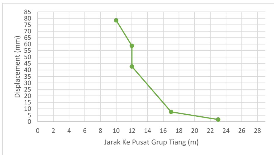
Gambar 7. Grafik 2 : Nilai Pergerakan Tanah Lateral Sesuai Bacaan Soil Inclinator
