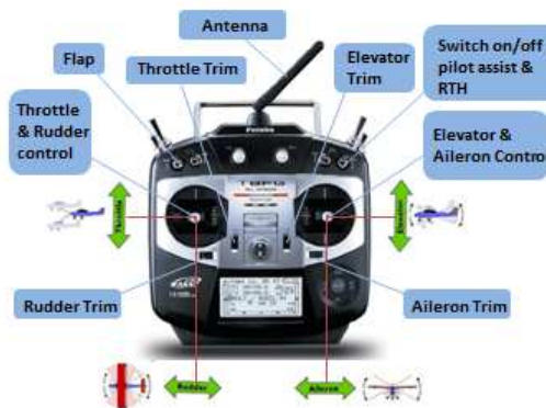
Gambar 4. Fungsi kerja stick kontrol pada radio transmitter 8 channel (sistem kendali pesawat)
