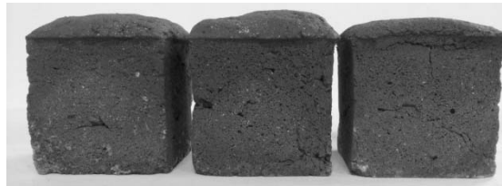
Gambar 4. Benda Uji dengan Pemuaihan yang Tidak Merata dan Bergelombang
