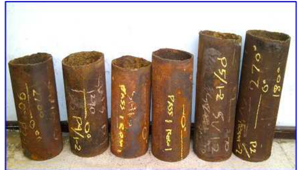
Gambar 3. Enam potongan pipa disekitar pipa yang pecah
