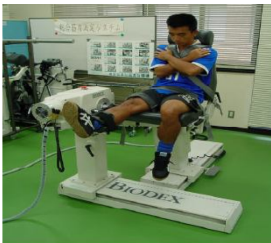
Gambar 2. Biodesex Isokinetik Dinamometer Digunakan untuk Mengukur Kekuatan Otot Kaki dengan Kecepatan, 60, 180, dan 300 Derajat/detik, Luas Gerakan (ROM) 90 0
