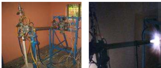
Gambar 1. (Atas) Diagram Skematik Sistem Pelapis D-Gun; (Bawah Kiri) Sistem Pelapis D-Gun yang Terdapat di Puslit Fisika LIPI; (Bawah Kanan) Sistem Pelapis D-Gun Saat Sedang Beroperasi
