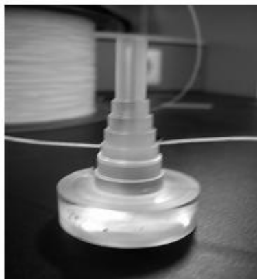
Gambar 4. Silinder acrylic dengan diameter bervariasi tempat serat optik dililitkan.
