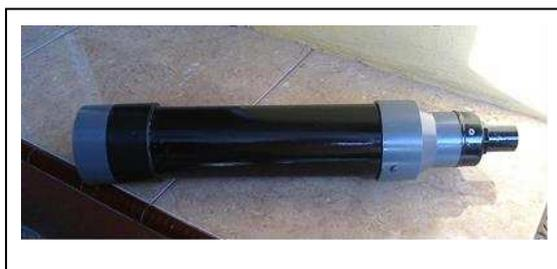
Gambar 3. Realisasi teropong bintang sederhana dari bahan pipa peralon menggunakan dua buah lensa cembung, yaitu lensa obyektif dan lensa okuler (untuk skala latihan:  $F_{ob} = 33,70\text{cm}$  dan  $F_{ok} = 19,07\text{cm}$ ).
