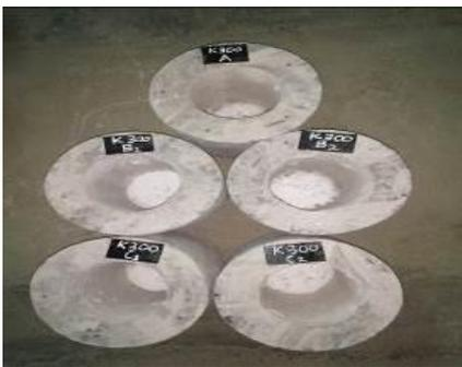
**Gambar 3** Gabus Dimasukkan pada Bagian Bawah *Spun Pile*
