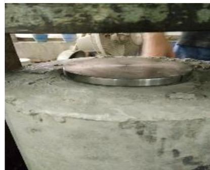
**Gambar 4** Plat Diletakkan di Bagian Atas *Spun Pile*
