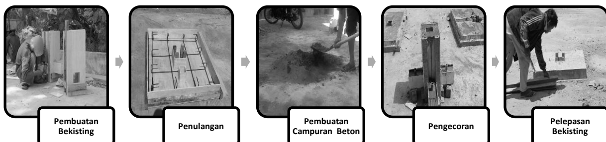
Gambar 4 Proses Pembuatan Sampel Interlocking
