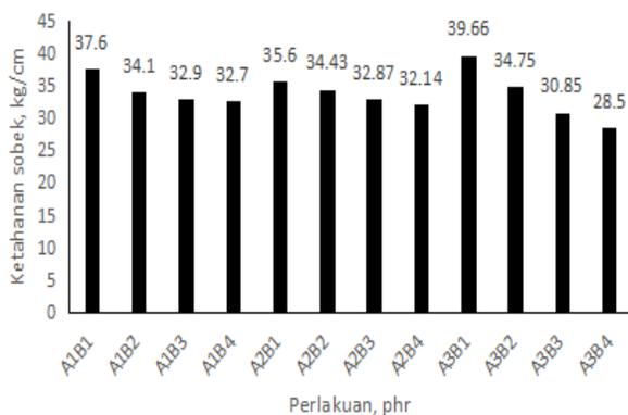
Gambar 3. Hasil uji ketahanan sobek kompon *Grip Handle*
