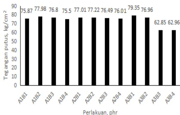
Gambar 1. Hasil uji tegangan putus kompon *Grip Handle*
