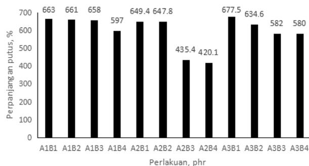
Gambar 2. Hasil uji perpanjangan putus kompon *Grip Handle*
