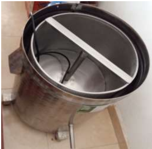
Gambar 2 Penggorengan tipe Gas Fryer JSS71
