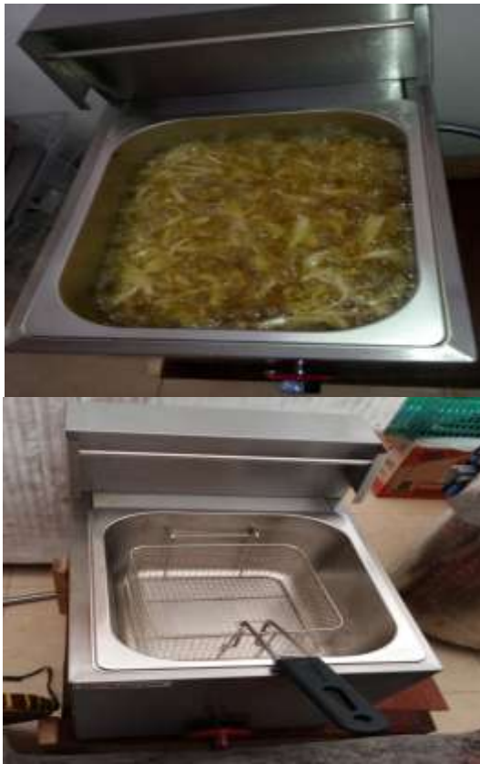
Gambar 2 Penggorengan tipe Gas Fryer JSS71
