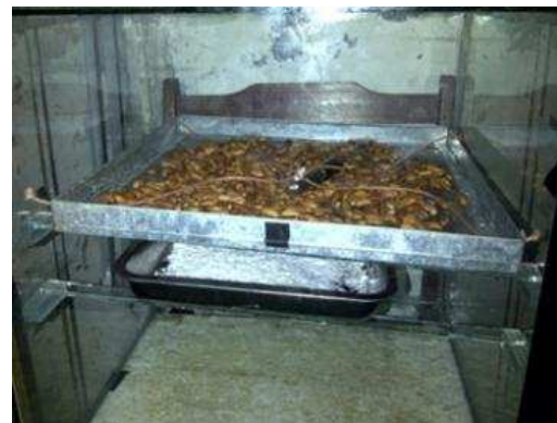
Gambar 1. Pengering Sistem Integrasi: (a) energi surya pada siang hari dan (b) termokimia – absorben pada malam hari
