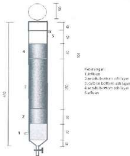
Gambar 2. Reaktor vertikal uji coba proses adsorpsi karbon aktif bottom ash pada effluen limbah tekstil
