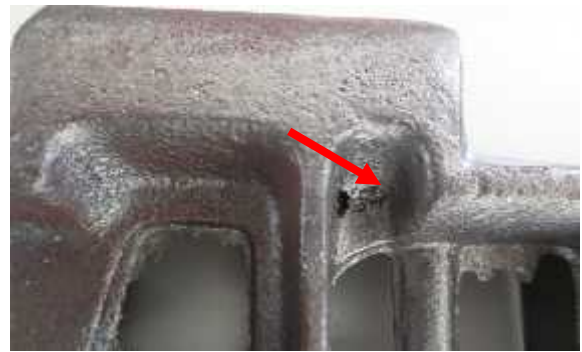
Gambar 6. Cacat penyusutan pada daerah celah
