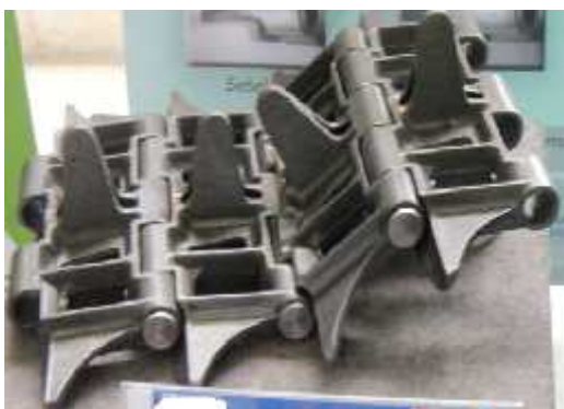
Gambar 2. Sampel empat buah track link hasil pengecoran yang sudah dirakit
