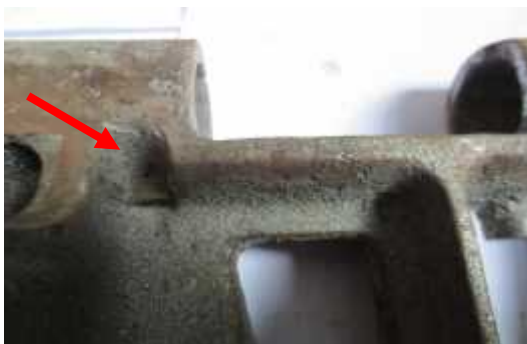
Gambar 10. Permukaan produk cor pada daerah celah menggunakan chill pada cetakan pasir silika
