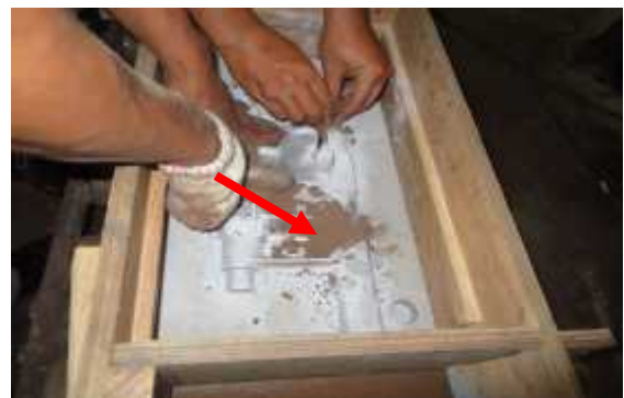
Gambar 9. Pemasangan pasir kromit pada daerah celah
