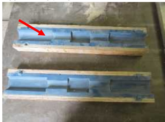
Gambar 13. Kotak inti hasil perbaikan
