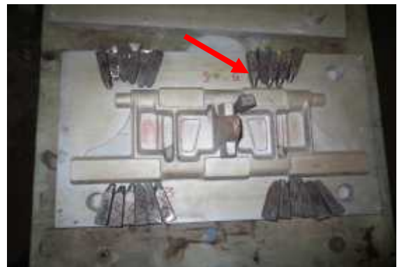
Gambar 7. Pemasangan chill pada pola
