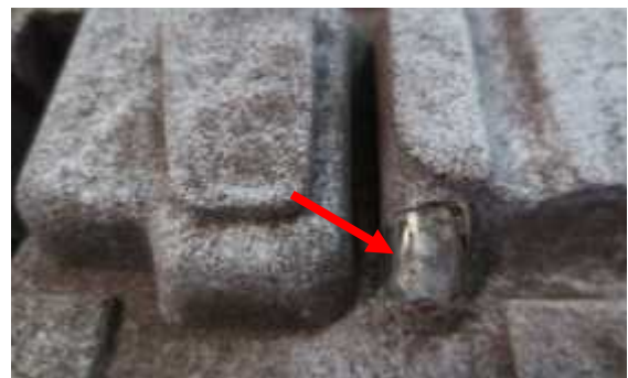
Gambar 8. Permukaan chill pada cetakan pasir
