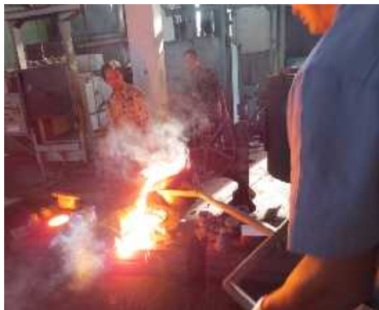
Gambar 15. Proses penuangan logam cair kedalam cetakan
