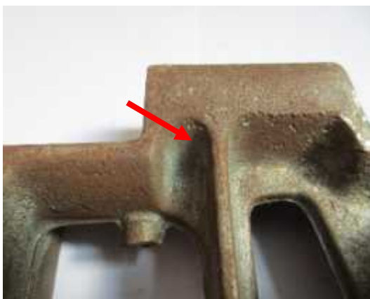
Gambar 11. Permukaan produk cor pada daerah celah menggunakan pasir kromit pada cetakan pasir silika
