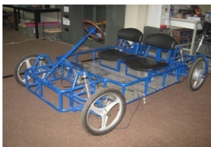
Gambar 8. Mobil elektrik mini.
