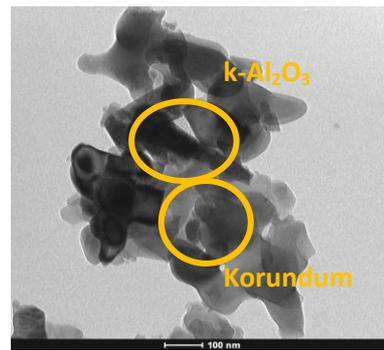
**Gambar 6.** Foto mikrostruktur TEM (*Transmission Electron Microscope*) nano alumina titania berbasis bayerit setelah dikalsinasi suhu 1000°C (AT 661 1000)
