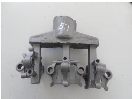
Gambar 3. Keseluruhan hasil cor yang terdiri dari cawan tuang, saluran pengalir, saluran masuk, dan produk cor "rocker arm".
