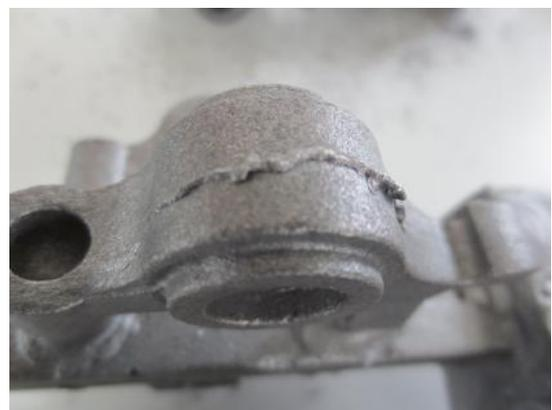
Gambar 9. Cacat penetrasi logam pada *rocker arm*
