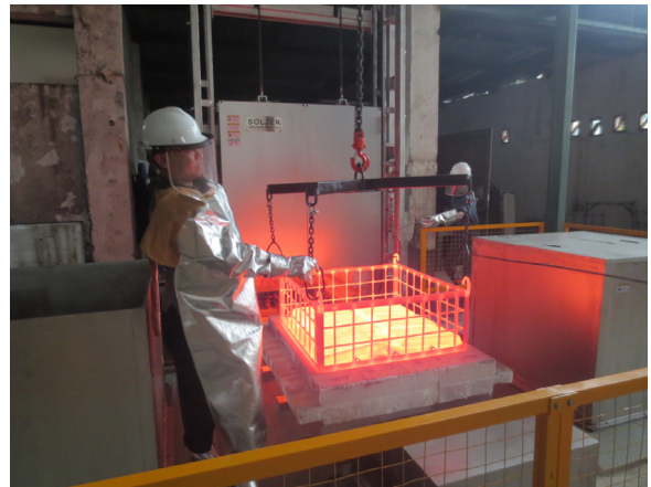
Gambar 5. Proses pengeluaran produk cor jaw plate dari dalam tungku perlakuan panas
