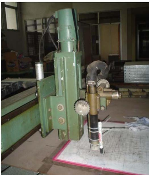
Gambar 6. Pengujian gerakan *end effector* mesin.
