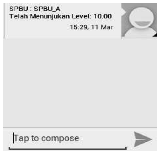
Gambar 22. Informasi level tangki SPBU dengan SMS gateway
