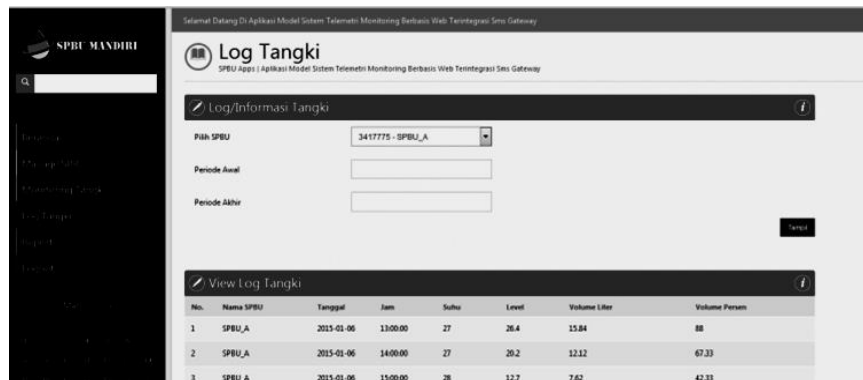
Gambar 17. Hasil uji coba monitoring tangki BBM SPBU-A
