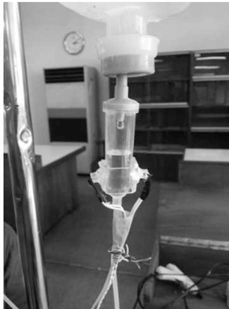
Gambar 9 Sensor Mendeteksi Adanya Cairan pada Tabung Tetes
